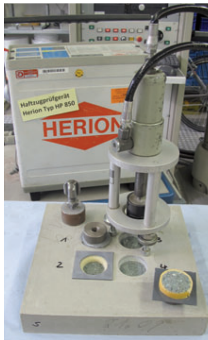
Prüfung der Oberflächenzugfestigkeit
