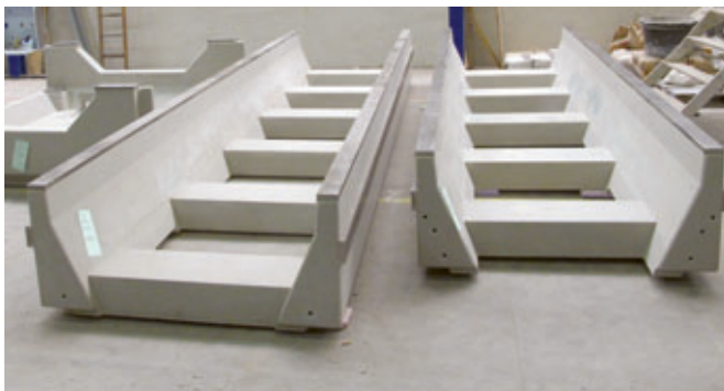
Betonkörper eines Maschinenbettes
