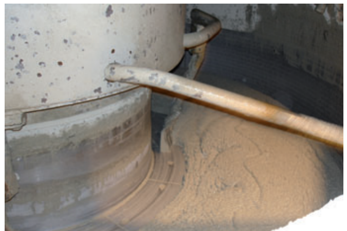
Mischen von Nanodur-Beton
