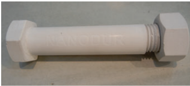
Betonschraube als Bestandteil eines Betonkanus
