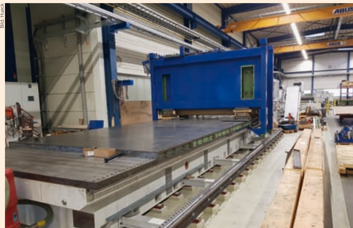
Das Maschinenbett aus Spezialbeton nach der Montage in der Halle des Werkzeugherstellers Hueck Engraving in Viersen.
