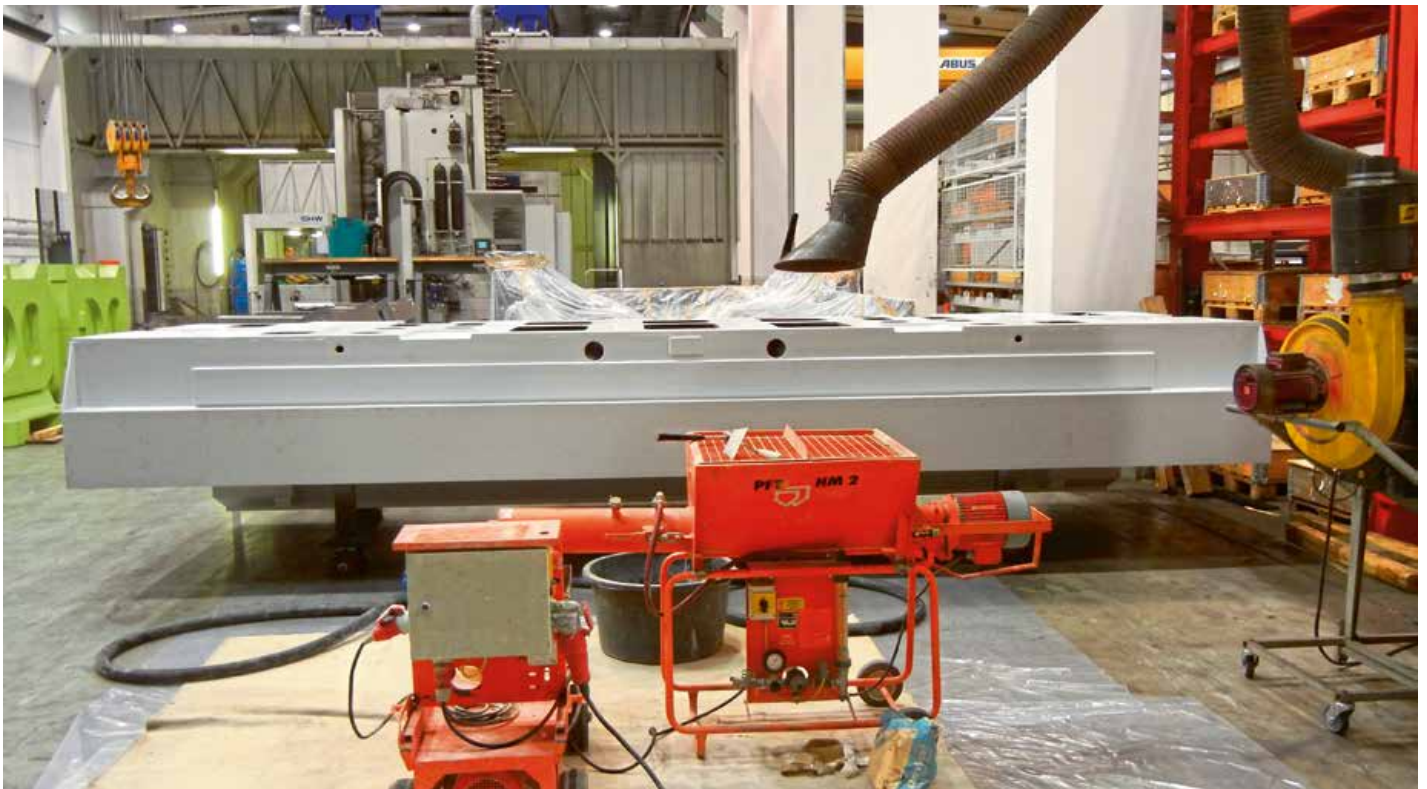
Bild 1: Verfüllen eines Maschinenbettes.
