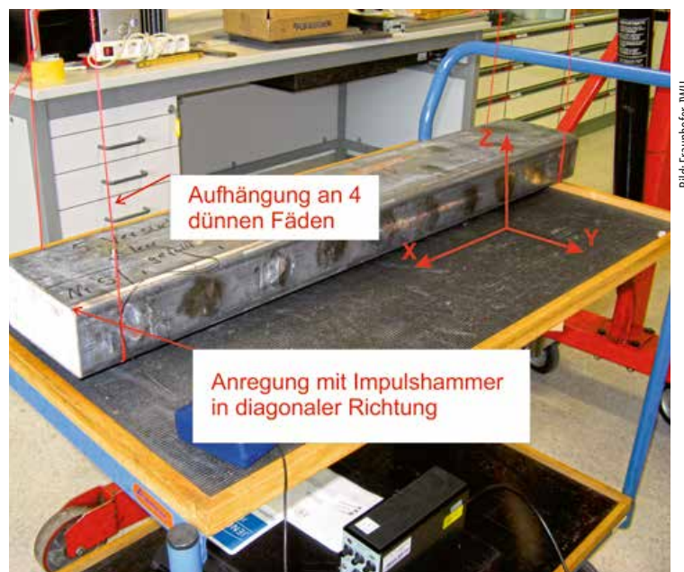
Bild 3: Im Bild zu sehen ist der Messaufbau mit aufgehängtem Profil.
